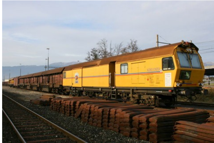
Train meuleur de rails (Scheuchzer S.A.)
